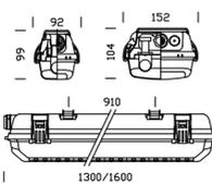
Corpo in policarbonato infrangibile ed autoestinguente stabilizzato ai raggi UV
