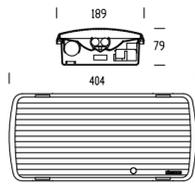
Corpo in policarbonato infrangibile ed autoestinguente stabilizzato ai raggi UV
